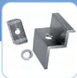
**M**PC-MPT sono morsetti non preassemblati in alluminio naturale utilizzati rispettivamente per il fissaggio centrale e terminale dei moduli fotovoltaici su profilati di sostegno. MPC e MPT sono costituiti da una staffa in alluminio completa di grower e dado a farfalla DDF e devono essere completati con la scelta della vite M8 in funzione dell'altezza del modulo.
