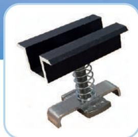
**M**PC-P sono morsetti in alluminio naturale utilizzati per fissare i moduli fotovoltaici su profilati di sostegno. MPC-P è un morsetto preassemblato per il fissaggio centrale del modulo, disponibile in diversi modelli in funzione dello spessore del modulo. SAF è una sfera antifurto che inserita nella testa a cava esagonale del bullone non permette in alcun modo di svitarlo.
