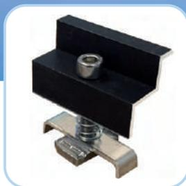
**M**PT-P sono morsetti in alluminio naturale utilizzati per fissare i moduli fotovoltaici su profilati di sostegno. MPT-P è un morsetto preassemblato per il fissaggio terminale del modulo, disponibile in diversi modelli in funzione dello spessore del modulo.
